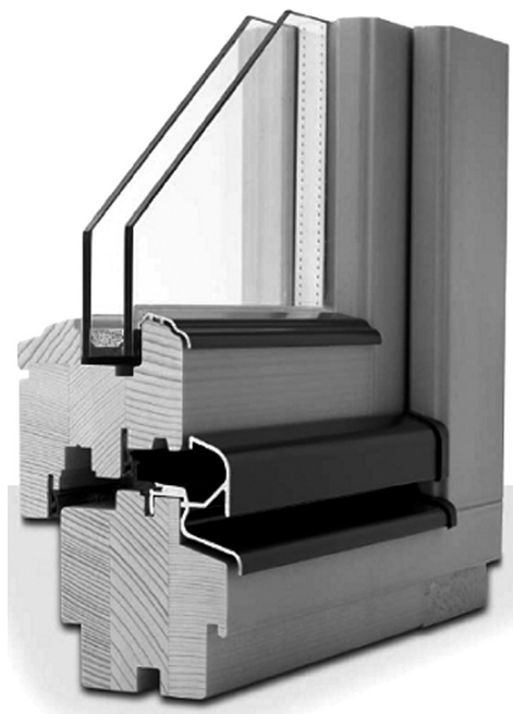
Fig. 6.3 Immagine tratta dalla brochure dell'azienda Internorm-Italia S.r.l., Gardolo (TN). Telaio in legno lamellare e gocciolatoio in alluminio su richiesta. Questo tipo di infisso con un vetro bassoemissivo contenente gas Argon o Krypton può arrivare a trasmittanze totali dell'infisso U_w < 1 \text{ W/m}^2\text{K} .
