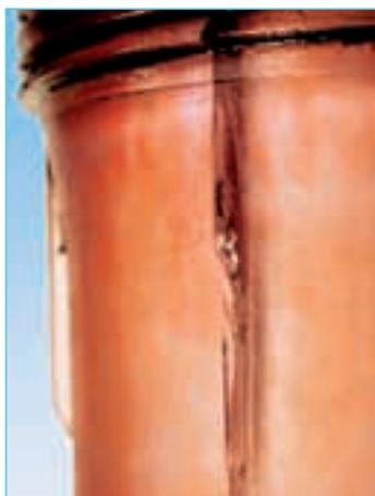
Figura 3: Rottura conseguente all'apertura errata del filtro senza la chiave ad anello
