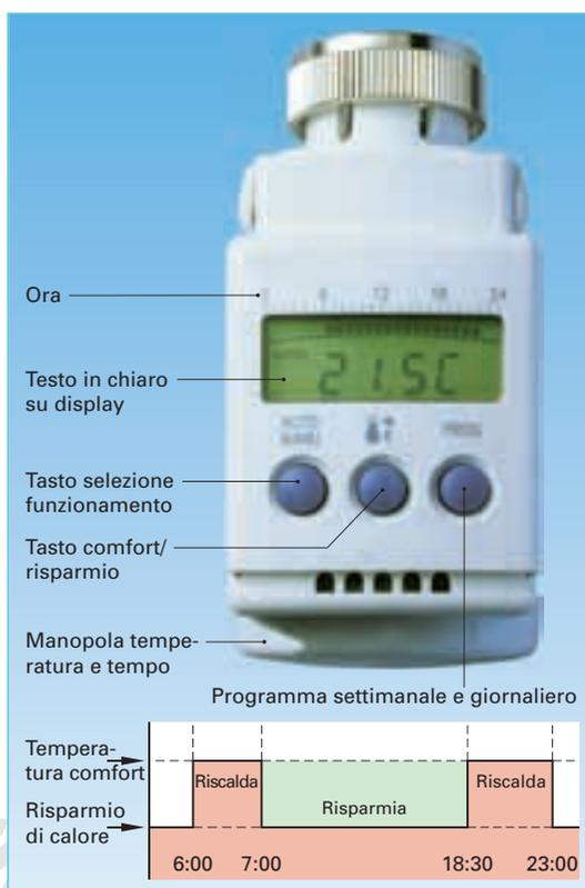
Figura 1: Controllo termostatico via radio
