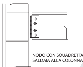
Figura 5.12 Nodo con piatti saldati.
