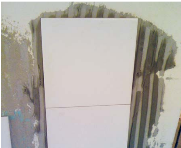
Le prove eseguite su LACOLLA hanno dato come risultato uno scivolamento in verticale nullo.
