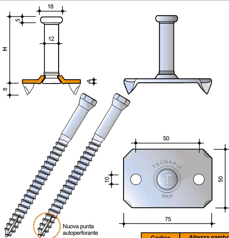
**Voce di capitolato:** connettore a piolo composto da una piastra di base 75 X 50 X 4 mm, modellata a ramponi, avente due fori atti al passaggio di due viti tirafondi Ø 10 mm, con sottotesta tronco-conico, gambo in acciaio zincato Ø 12 mm, unito alla piastra tramite ricalco a freddo. Altezze gambo disponibili: 20, 30, 40, 60, 70, 80, 105, 125, 150, 175 e 200 mm. Lunghezza viti disponibili: 100, 120 e 140 mm, certificato CE.
