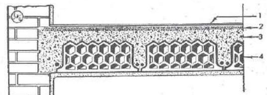
Fig. 44 — SOLAIO "ADAMOLI". - 1 Pavimento - 2 Sottofondo - 3 Giettata in calcestruzzo di cemento - 4 Foraloni ad alveare.
