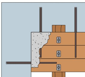
Per ottenere un efficace collegamento perimetrale si può realizzare un foro inclinato verso il basso nelle murature perimetrali all'altezza della soletta, iniettare in esso le resine Tecnar, inserire la barra ad aderenza migliorata in acciaio, piegando infine la barra in orizzontale all'interno della soletta.
