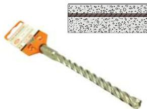
Punta per calcestruzzo extratagliante, diametro **11 mm**, lunghezza utile 100 mm, attacco SDS Plus, con quattro taglienti, idonei per forare anche le barre di armatura.
