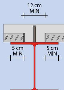
**Esempi di connessione con piolo con testa del tipo saldato.**
