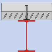
**Esempio di connessione con connettore CTF Tecnaria fissato attraverso lamiera continua.**
