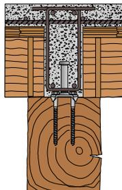
Connettore su trave principale con armatura di collegamento alla parte superiore della soletta.
