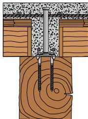
Connettore su trave principale: la testa del connettore deve superare la rete elettrosaldata. Il raccordo può non avere le staffe se correttamente dimensionato.
