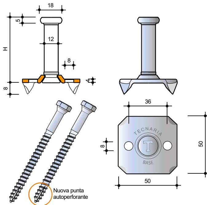
**Voce di capitolato:** connettore a piolo composto da una piastra di base 50 X 50 X 4 mm, modellata a ramponi, avente due fori atti al passaggio di due viti tirafondi Ø 8 mm, con sottotesta tronco-conico, gambo in acciaio zincato Ø 12 mm, unito alla piastra tramite ricalco a freddo. Altezze gambo disponibili: 20, 30, 40, 60, 70, 80, 105, 125, 150, 175 e 200 mm. Lunghezza viti disponibili: 70, 100 e 120 mm, certificato CE.
