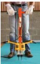
Due trapani elettrici montati su un telaio ergonomico permettono di eseguire due fori contemporaneamente alla distanza corretta nel legno per alloggiare le viti del connettore MAXI.
