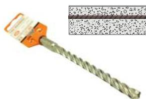
Punta per calcestruzzo extratagliante, diametro **8 mm**, lunghezza utile 100 mm, attacco SDS Plus, con quattro taglienti, idonei per forare anche le barre di armatura.
