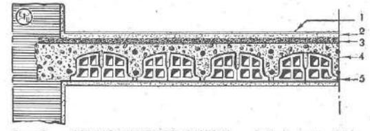
Fig. 43 — SOLAIO "MIOZZO SALERNI". - 1 Pavimento - 2 Lastre isolanti - 3 Sottofondo - 4 Giettata in calcestruzzo di cemento - 5 Foraloni in laterizio.
