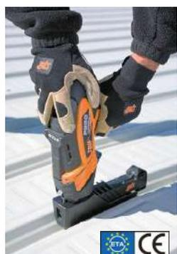
La chiodatrice Spit P560 dotata di uno speciale kit "caricatore" (cod. 013952), si può utilizzare anche per chiodare la lamiera grecata alle travi in acciaio, sia nel caso di solai che di tamponamenti verticali.
