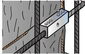
La chiusura meccanica delle staffe mediante i **manicotti GTS** avviene grazie all'azione di chiodi inseriti forzatamente.
