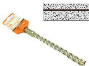
Punta per calcestruzzo extratagliante, diametro **10 mm**, lunghezza utile 100 mm, attacco SDS Plus, con quattro taglienti, idonei per forare anche le barre di armatura.
