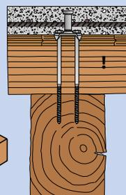
Connessione non efficace. Questo genere di connessione non è praticabile, in quanto la vite non è in grado di trasmettere gli sforzi di taglio. Di fatto sarebbe inutile.
