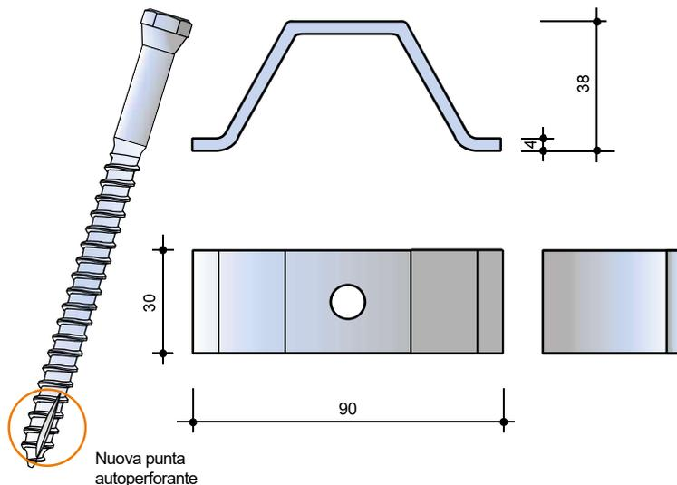
**Voce di capitolato:** connettore composto da una vite tirafondo Ø10 mm, lunghezza 100/120/140 mm con sotto-testa tronco-conica e da una piastra H38x30xL90 mm, spessore 4 mm piegata a forma di Omega, avente un foro atto al passaggio della vite tirafondo, certificata CE.
