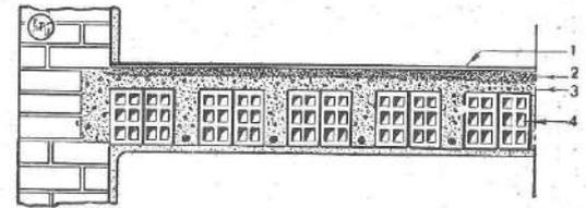
Fig. 42 — SOLAIO IN CEMENTO ARMATO E MATTONI FORATI COMUNI. - 1 Pavimento - 2 Sottofondo - 3 Giettata in calcestruzzo di cemento - 4 Mattoni forati.
