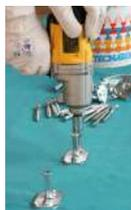
Avvitatore elettrico a impulsi; per le sue caratteristiche ideale a fissare le viti dei connettori nel legno, attacco quadro da 1/2".
